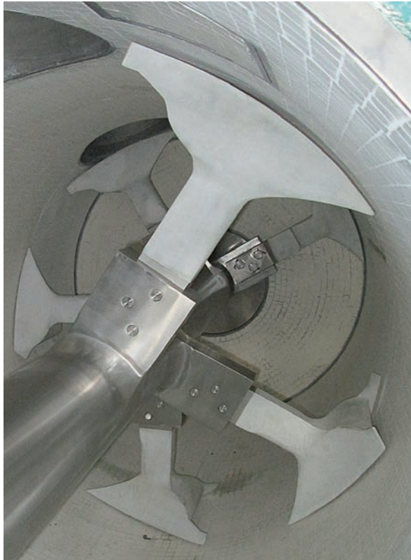
混合筒带有陶瓷贴片内衬，犁铧带有氧化陶瓷涂层
