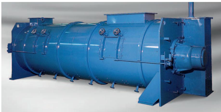
当物料量大且不间断来料时，常用到连续式强力混合器。我们将根据已有经验及实验来为您选择最适合的材质、配件及适合的填充度。物料在混合器内的停留时间由物料的性质和系统各个元件的配置以及进出口的设置来决定。
