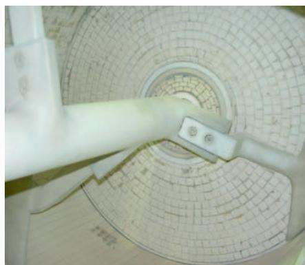
筒体内壁带有氧化铝的陶瓷内衬，搅拌轴也具有相应图层
