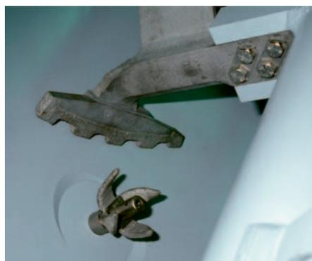
锯齿形犁铲及侧刀通过硬质合金焊接
