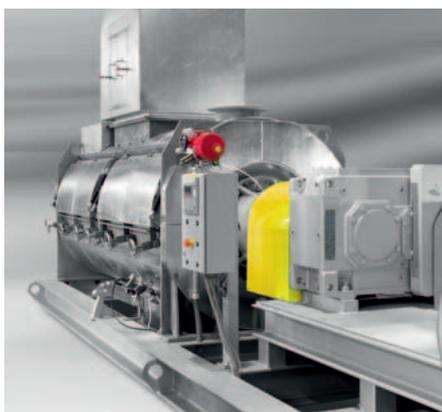
左图 KM 20000 D 型犁铧连续混合机，主要应用于精矿球团造粒前的预混料
