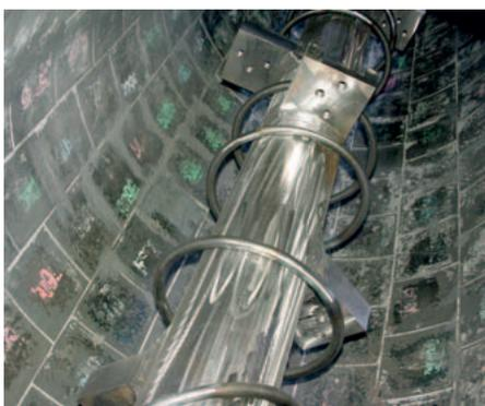
筒体内壁带有熔铸岩内衬
