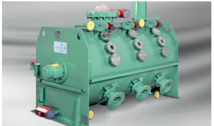
FKM 1200型间歇式强力混合器，带热源，应用于多种不同性状原材料的混合。
